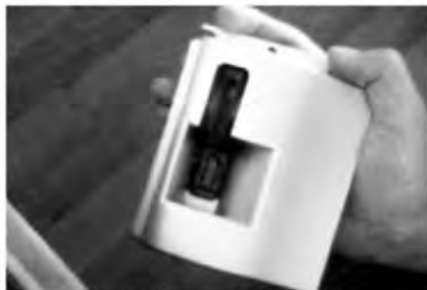
复制器中的芯片装入插卡口，用来偷卡号。
